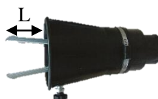
Entonnoir en caoutchouc pour échappements intégrés dans le pare-chocs, équipée avec une pince interne et prise C.O (Ø 32 mm).
